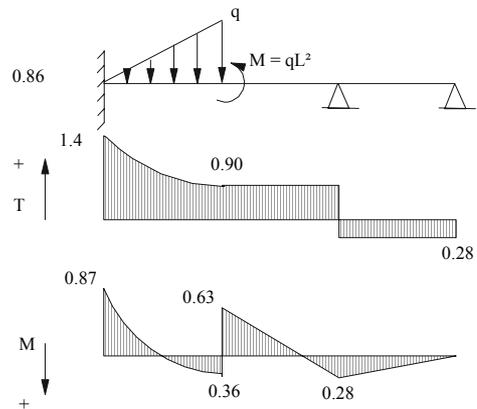
L'appui 2 est considéré comme appui double de rive quand  $K \rightarrow \infty$ , et dans ce cas on a:
