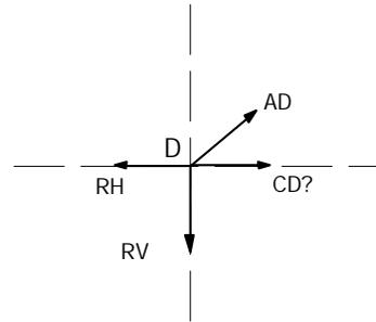
Le système doit supporter la charge  $P$  suivant toutes les directions possibles. Etant données les directions les plus défavorables correspondent à  $\alpha = 45^\circ$  et  $0^\circ$ ; on remplace dans les expressions des efforts les valeurs de  $\alpha$ , et on obtient:
