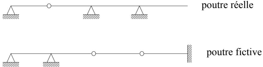
Le diagramme positif du moment fléchissant de la poutre réelle agit sur la poutre fictive de haut en bas et le diagramme négatif du moment fléchissant de la poutre réelle agit sur la poutre fictive de bas en haut.
